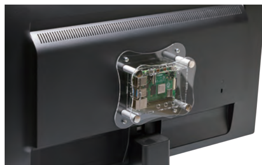
RPA-4B・5-1FはVESA規格の取付ピッチ(100×100mm)に対応しており、PCディスプレイの裏側に取付けが可能です。
